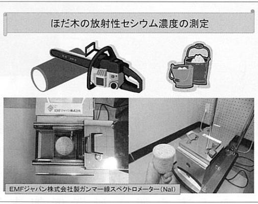
図2 ほだ木の放射性セシウム濃度の測定
